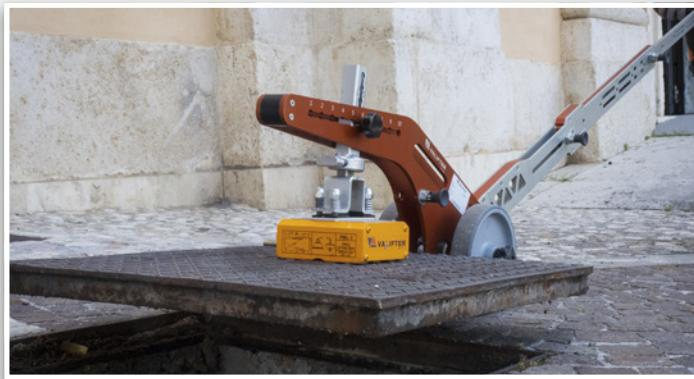
El imán Rhino Slim Damped no requiere alimentación eléctrica, permite **realizar intervenciones rápidamente** sin renunciar a la seguridad, libera al operario de la búsqueda, limpieza y uso de los puntos de enganche colocados en las tapas de las alcantarillas.
