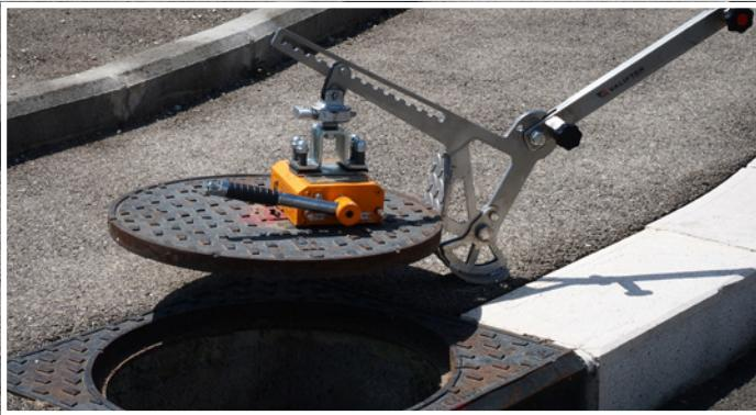
La fuerza del neodimio, la activación manual y el revestimiento aislante de aluminio evitan que el circuito atraiga materiales no deseados, limitan la exposición del trabajador al campo magnético y garantizan la longevidad del equipo y su funcionamiento seguro a lo largo del tiempo.
